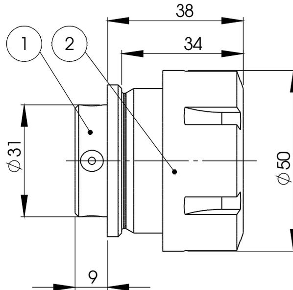
Spannzangenaufnahme ER 32
